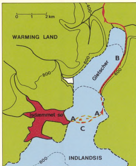
Figur 5. Kort visende placeringen af den isdæmmede sø, med gletscheren der havde spærret for afløbet. Vandet er tappet gennem en afstrømningskanal under isen (A) og ned i dalen langs gletscherens østside (B). Den caldera-agtige indsynkning er vist midt i gletscheren (C).
