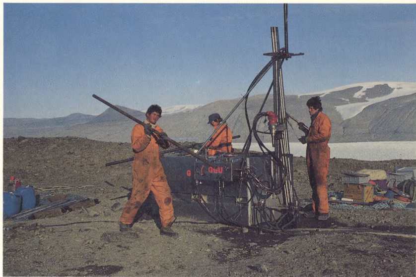
Figur 2. Boring med GGU's kerneboringsudstyr.
