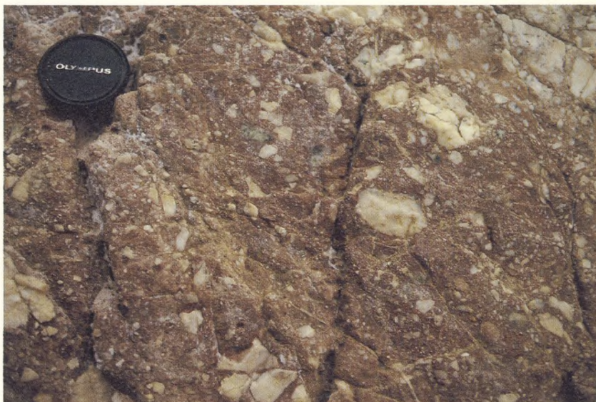
Figur 5. Nærbillede af den centrale del af åren og visende knusningszonen imprægneret med zinkblende.
